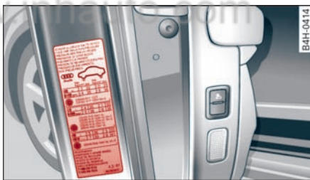
图 234 已打开的驾驶员车门：轮胎充气压力表
