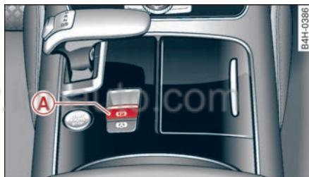
图 103 中控台: 驻车制动器
