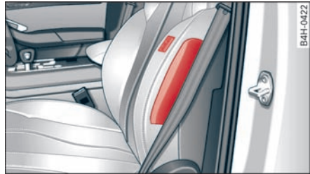
图 204 驾驶员座椅上侧面安全气囊的安装位置
