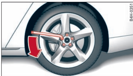
图 247 车轮: 松开车轮螺栓
