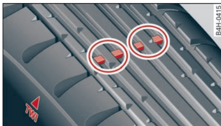
图 235 轮胎花纹：磨损指示
