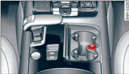
图 70 打开的前烟灰缸：点烟器
