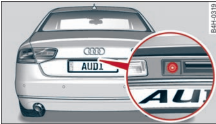
图 162 行李箱盖：倒车摄像头的安装位置
