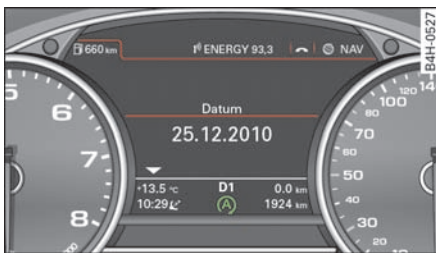
图 105 组合仪表：发动机已关闭（停机阶段）
