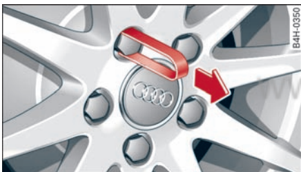
图 245 车轮: 车轮螺栓装有封盖的汽车
