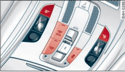
图 42 前车顶篷：内部照明灯的操作件
