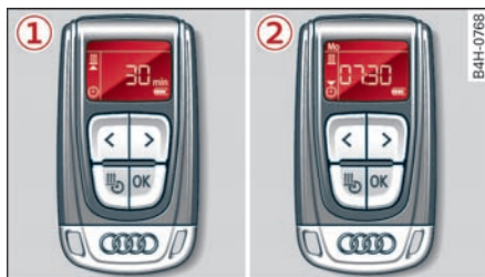
图 98 驻车暖风遥控器: ① 马上开启, ② 设置定时
