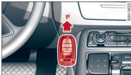
图 102 中控台/无线遥控钥匙: 出现故障时启动发动机
