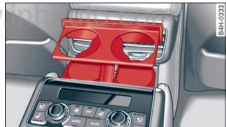
图 82 后座椅放大图: 后饮料罐托架
