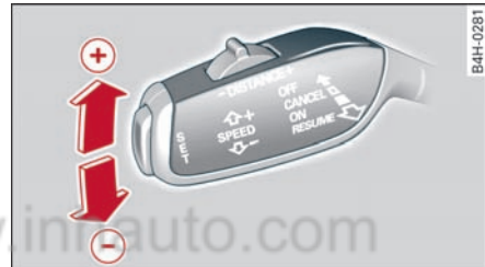
图 131 操控拨杆：改变车速。
