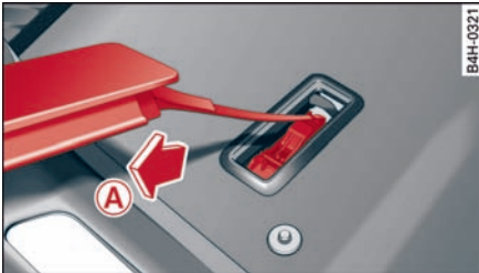
图 123 驾驶员放脚空间：应急打开驻车锁止
