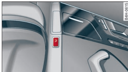
图 95 B 立柱：电离空气清洁剂按钮
