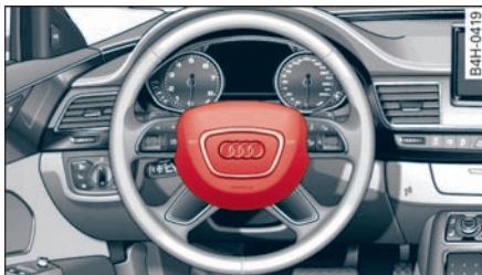
图 200 方向盘：驾驶员安全气囊
