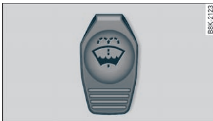
图 233 发动机舱：车窗玻璃清洗液储液罐盖
