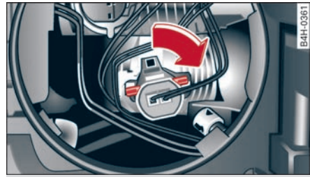
图 274 灯泡插头：导向凸缘
