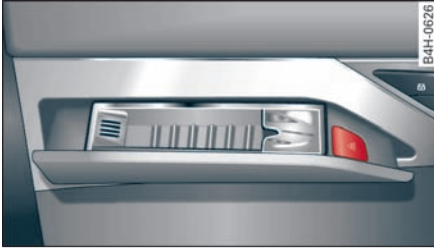
图 69 后车门：雪茄托架及烟灰缸
