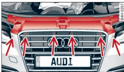
图 267 发动机舱：挡盖和固定件
