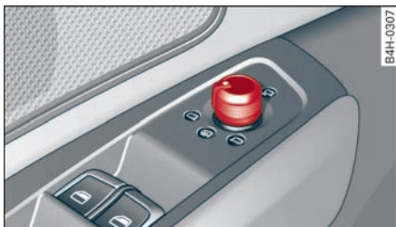
图 45 驾驶员车门：车外后视镜旋钮
