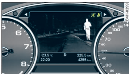
图 153 组合仪表：行人标记和警告铃声已被关闭时的示例
