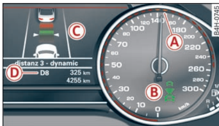
图 130 组合仪表：自适应巡航控制
