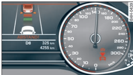
图 134 组合仪表：要求驾驶员接管驾驶操控
