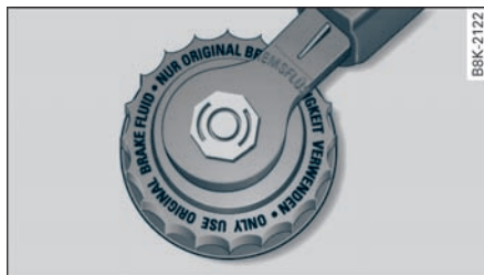
图 231 发动机舱：制动液储液罐盖
