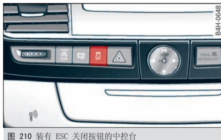
图 210 装有 ESC 关闭按钮的中控台
