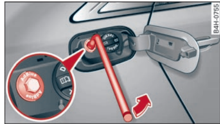
图 221 汽车的右后部: 拧出 AdBlue 封盖
