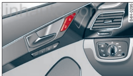
图 20 驾驶员车门：中央门锁开关
