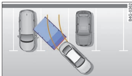
图 159 原理图：横向泊车
