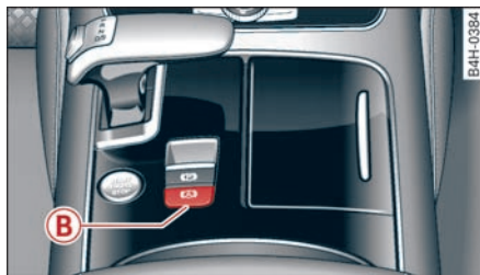
图 104 中控台：起步辅助系统按钮
