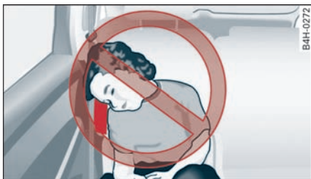
图 184 侧面安全气囊展开部位的危险坐姿图解。
