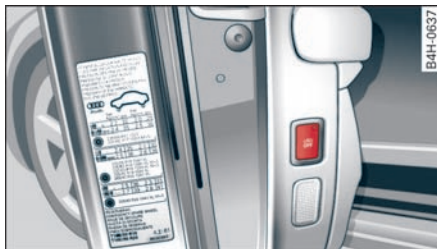
图 24 驾驶员车门前端：车内监控和防拖车监控功能按钮
