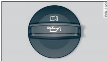
图 229 发动机舱：发动机机油加注口盖
