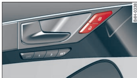
图 21 后座车门：中央门锁开关
