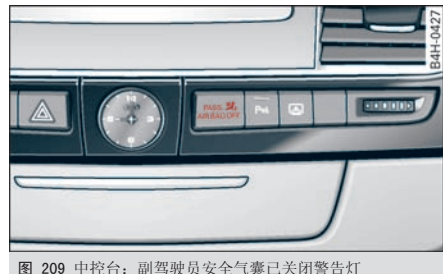
图 209 中控台：副驾驶员安全气囊已关闭警告灯
