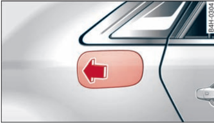
图 216 汽车的右后部：打开油箱盖
