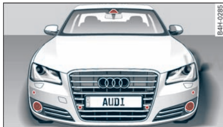
图 125 车辆前部：传感器和摄像头
