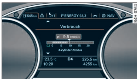
图 10 组合仪表：4 缸发动机模式
