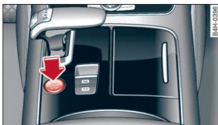
图 101 中控台：START ENGINE STOP（发动机启动及关闭按钮）
