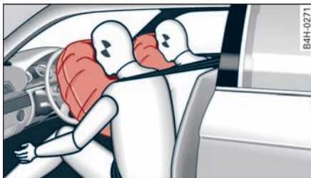
图 202 已胀开的前部安全气囊
